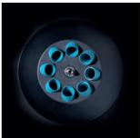
rotor angulaire, 8 places | 33°   | 6.000 min <sup>-1</sup>  <br>8.000 min <sup>-1</sup> | 8x15 ml       | <b>INCLUS</b> | 3    |
